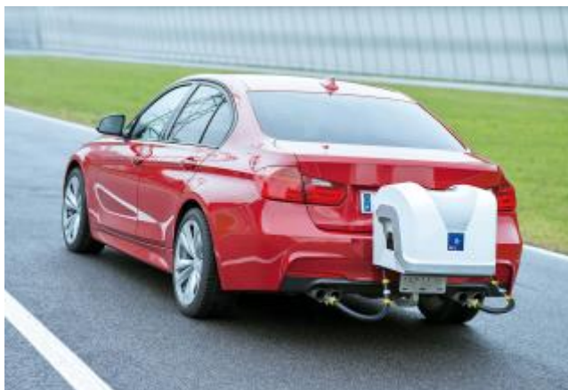
Фиг.6 Мобилно устройство, прикрепено към автомобил BMW 320d F30 2016/2017 за реално отчитане на отделените токсични компоненти
